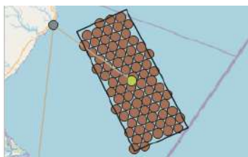
Figura 8 – Distribuição dos aerogeradores para o Parque Eólico Offshore Hollandse Kust Noord pela metodologia proposta.
