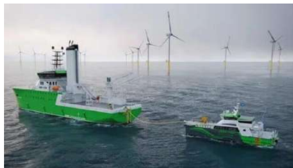
c) Conceito de carregamento vessel-to-vessel da Damen
