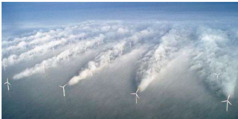
Figura 1- Fenômeno do wake effect. Fonte: (RECHARGE, 2019).
